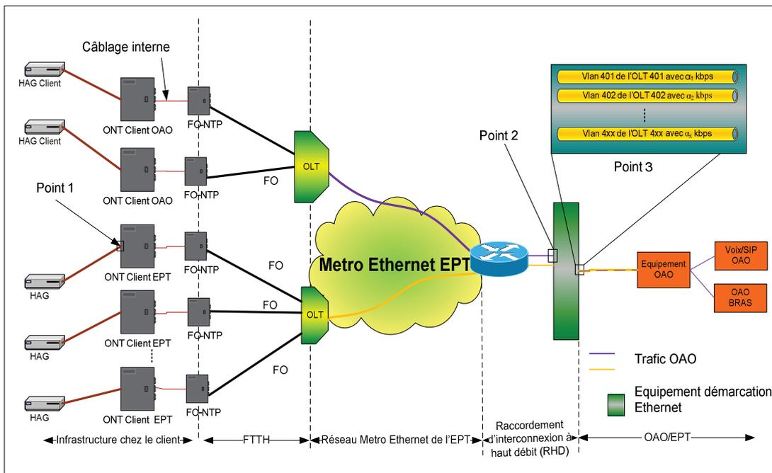
**Point 1 :** Le point de terminaison chez le Client Final est une interface Ethernet RJ45 IEEE 802.3ab avec 1.000Mbps en download et 500Mbps en upload, full duplex, forced sur l'ONT (Optical Network
