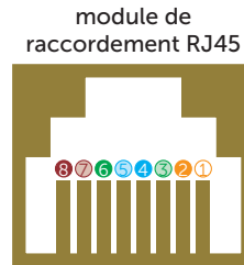
Figure 23 Connecteur et module de raccordement RJ45
