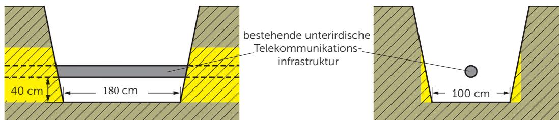
**Abb. 7 Abmessungen der Anschlussgrube für unterirdische Anschlüsse**
