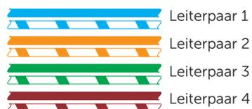
Abb. 29 Farbcode und Zählweise eines Netzwerkkabels (EIA/TIA-568B)
