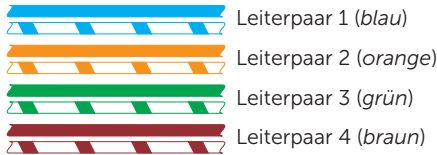
Abb. 22 Farbcode und Numerierung des Netzwerkkabels (EIA/TIA-568B)
